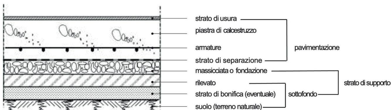
Nella Figura 2 è illustrata la sequenza tipica della stratigrafia che costituisce una pavimentazione di calcestruzzo realizzata su massiccata posta direttamente su terreno
